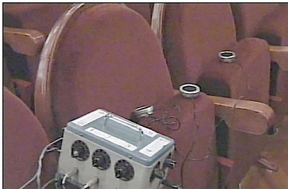
La instalación de estos dispositivos en el teatro exigió la superación de ciertos problemas de equipamiento, al ser necesaria la distribución de los respectivos *sensores* en cada una de las butacas de la sala, y del sistema de cableado correspondiente desde las cajas distribuidoras, lo que permitía el acceso a la música interpretada desde cualquier emplazamiento de la sala.
